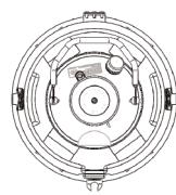
La espuma que amortigua los golpes en el PPSC ayuda a prevenir daños al dewar. La ilustración muestra la vista superior del depósito en el PPSC.
