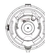
A espuma de absorção de impacto no PPSC ajuda a evitar danos ao dewar. A ilustração mostra uma visão superior do tanque no PPSC.
