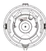
La mousse absorbant les chocs contenue dans le PPSC aide à prévenir les dommages au dewar. L'illustration montre la vue de dessus du réservoir dans le PPSC.
