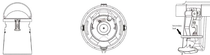
Die Abbildung zeigt einen typischen Transportbehälter aus Kunststoff (PPSC). Die Form des Transportbehälters gewährleistet, dass das Produkt aufrecht stehend transportiert wird.
